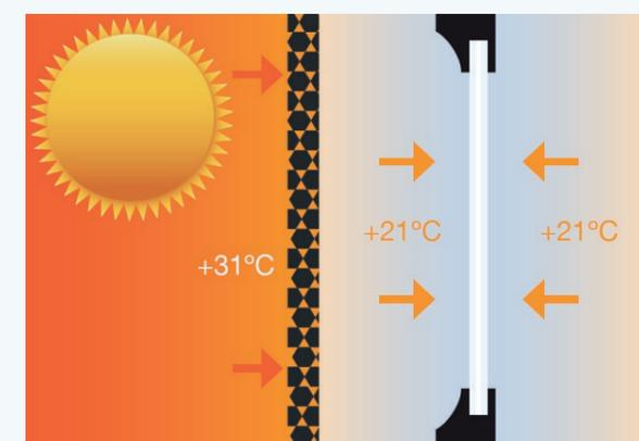
El panel thermic también aísla frente al calor. Cuando la temperatura exterior es elevada, la contraventana proporciona un bloqueo que hace que se forme una zona de aire fresco entre esta y la ventana, para que así los cristales no se calienten y poder mantener la temperatura interior estable.
