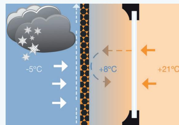
Las contraventanas con panel thermic son un excelente aislante que bloquea el aire frío proveniente del exterior. A su vez, mantiene el aire caliente entre la ventana y la contraventana, de forma que la temperatura se mantiene estable, aún con golpes de viento, sin necesidad de aportación energética suplementaria en el interior.
