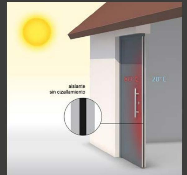
Con el perfil aislante sin cizallamiento, la zona aislante móvil compensa las diferentes dilataciones longitudinales de la cara interior y la exterior.
